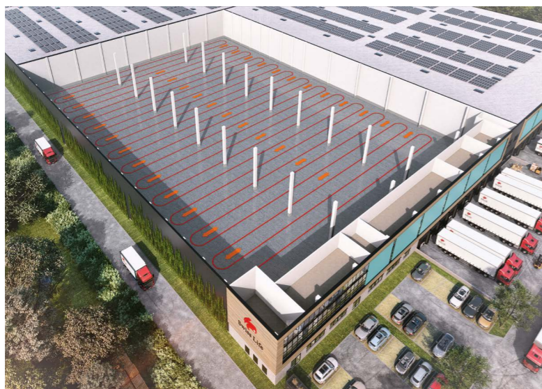
Integrierte Heiz- und Kühlschlaufen im Industrieboden der Halle
